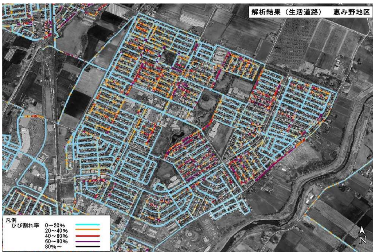
図 2-12 生活道路のひび割れ率調査結果（恵み野地区）
