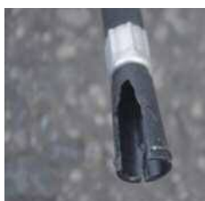
× ノズルの破損
