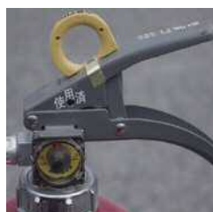
× 表示装置の脱落
