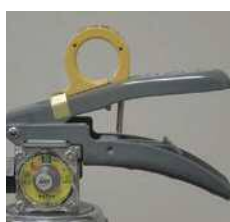
× レバー支えの脱落
