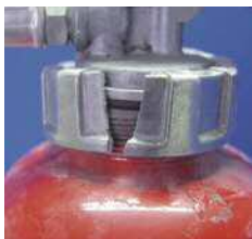
× キャップの破損
