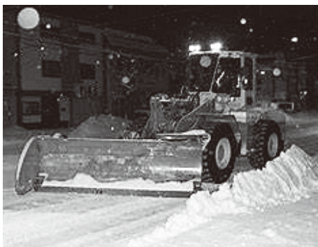
稼働する除雪ドーザ
