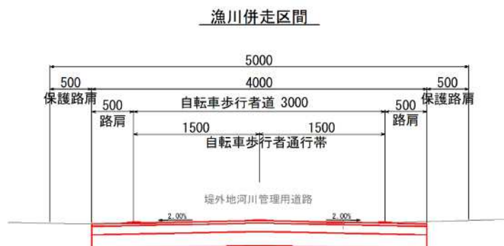
〈図4 漁川併走区間 横断面図〉
