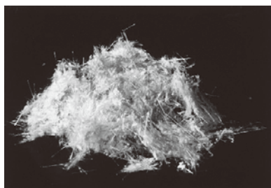
有害物質のアスベスト（石綿）
