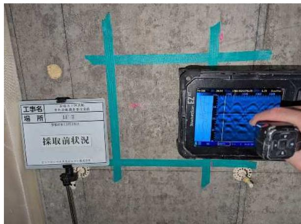
写真 7.2 鉄筋探査状況
