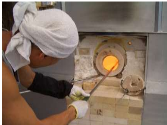
② まき上げる 1300度の熱で溶かした ガラスをまき上げる。
