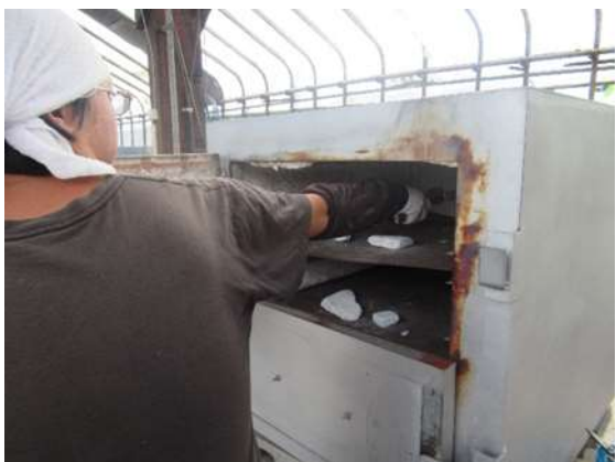
⑥ 冷ます 温度の低い炉で、一晩かけてゆっくり冷まします。
