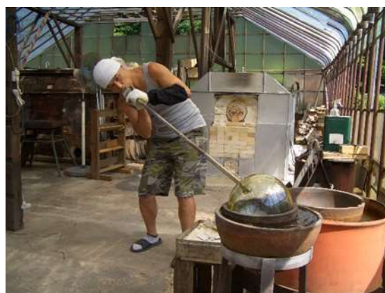
④ 形を整える 型を使いながら、どこも同じ厚さの玉になるように整えます。
