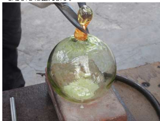
⑤ ヘそをつける 息のふきこみ口を溶かしたガラスでふさぐ。
