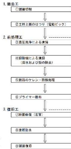
図 5-1 H30 断面修復の施工手順
