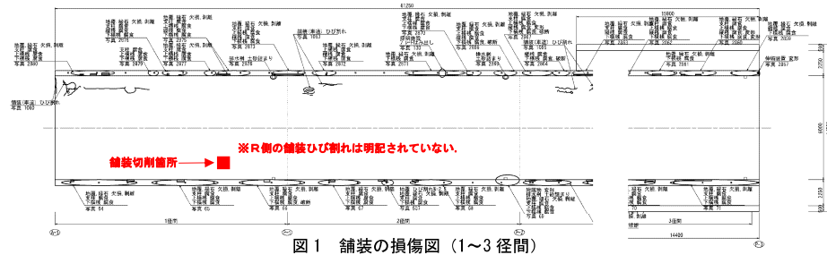
図1 舗装の損傷図（1～3径間）
