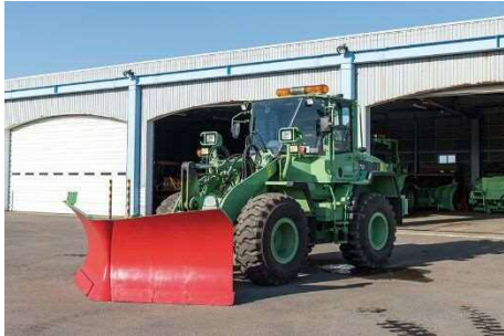
除雪ドーザー
