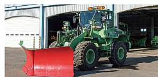
除雪ドーザー
