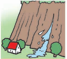
斜面から水がふき出す
