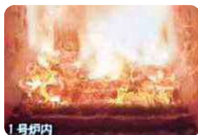
焼却炉 ごみを850℃以上の高温で燃やすことで、ダイオキシン類の発生を抑制します。
