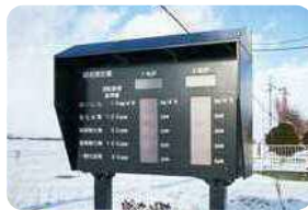
環境モニタリング装置 運転中の排ガスデータを常に公開しています。
