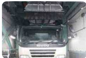
灰搬出室 焼却後の灰は水で満たされた灰搬出装置で消火・冷却され、灰搬出室から場外へ搬出します。
