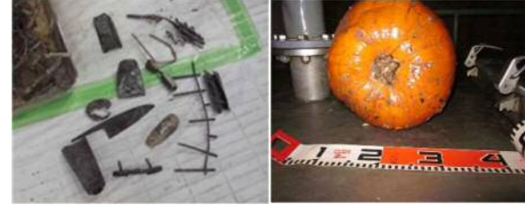
包丁・缶類・針金など ハロウィンかぼちゃ 施設に混入した不適物類
