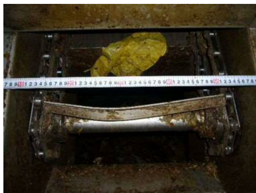
異物により機械が大きく曲がった様子
