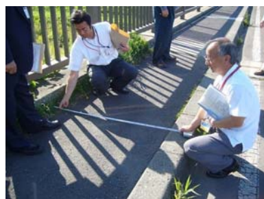
橋の上では十分な歩道幅員が確保されていません
