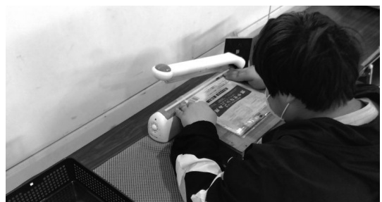
袋詰めした製品の外袋を熱溶着して閉じる
